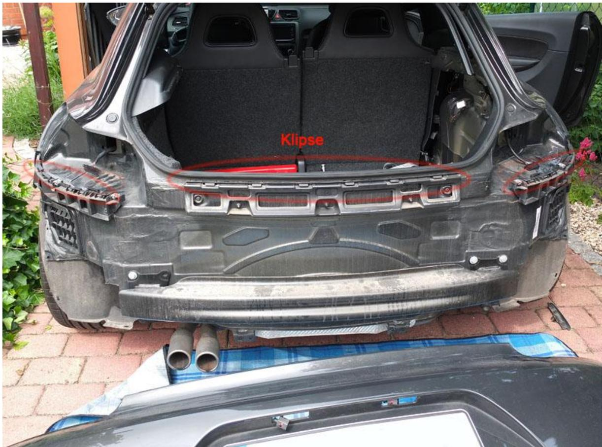
Nun steht der Kabeldurchführung von innen nichts mehr im Weg. Durch den innen gut sichtbaren Gummipfropfen, rechts hinten, kann mit sanfter Gewalt das Ende von Kamerakabel, das von vorne kommt, durchgesteckt werden. Bei Zenec muss danach allerdings ein Stromkabel (blau) nochmal zurückgeführt werden um später im Innenraum an das Kabel des Rückfahrscheinwerfers angeschlossen zu werden.
