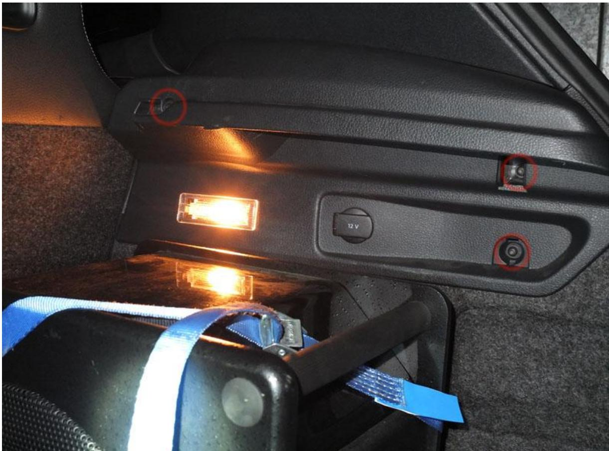
Entfernt nun die Kabel der Kofferraumbeleuchtung und der Bordsteckdose.
